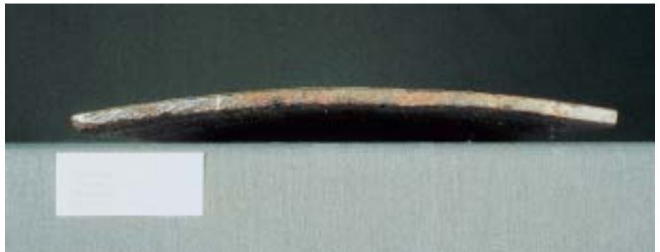
Abb. 2: Unterkante Brettbahn 4. Die Verwerfung der Brettbahn ist deutlich zu erkennen, partiell maß sie bis zu 21 mm.
