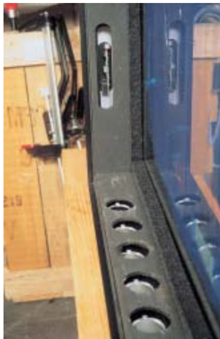
Abb. 3: Innenansicht der Klimavitrine. In die Vitrine wurde innen ein Sperrholzrahmen zum Fixieren des Tafelgemäldes eingebaut. Die Öffnungen im Boden und an der linken Seite wurden ausgespart, um die Wirkung von Art-Sorb®-Ausrüstung und Sensorelektronik nicht zu beeinträchtigen. Auch bei eingestellter Brettbahn bleiben diese Öffnungen frei.
